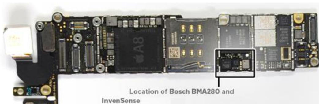
**Figura 19 - Localização dos sensores BMA-280 e MPU-6500 no iPhone 6s (Dixon-Warren, 2014)**
