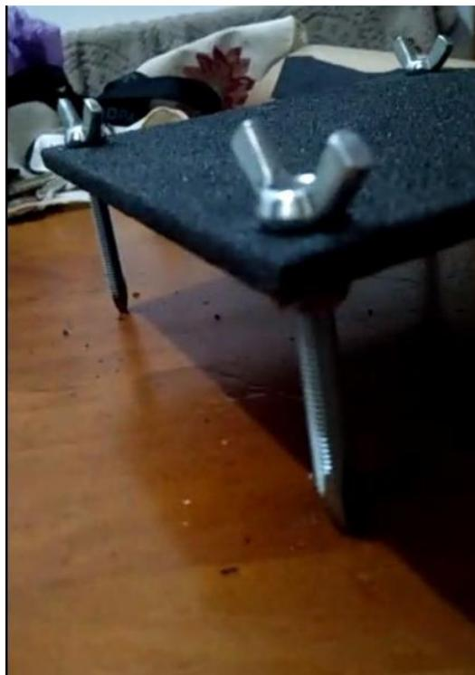
**Figura 37 – Case desenvolvida para o iPhone (aplicação dos parafusos com porca de orelhas)**
